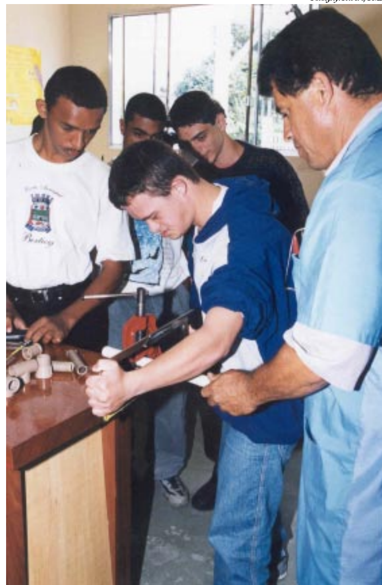
Entre as matérias lecionadas no curso, os alunos aprendem a cortar e fazer roscas em tubos de PVC
