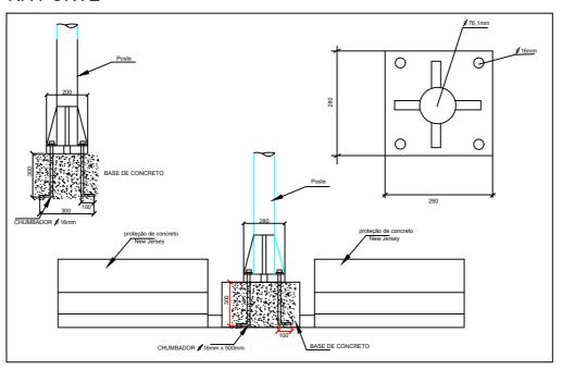
Montagem completa do poste galvanizado com luminária e base de fixação na ponte
