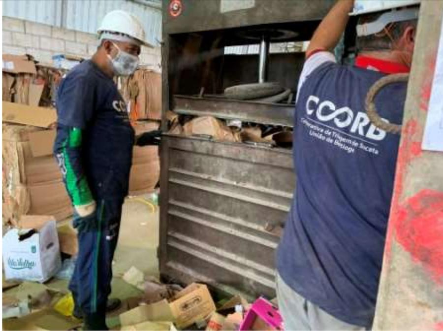
Foto 8 – Rasgador de sacos sem proteção às partes móveis.
