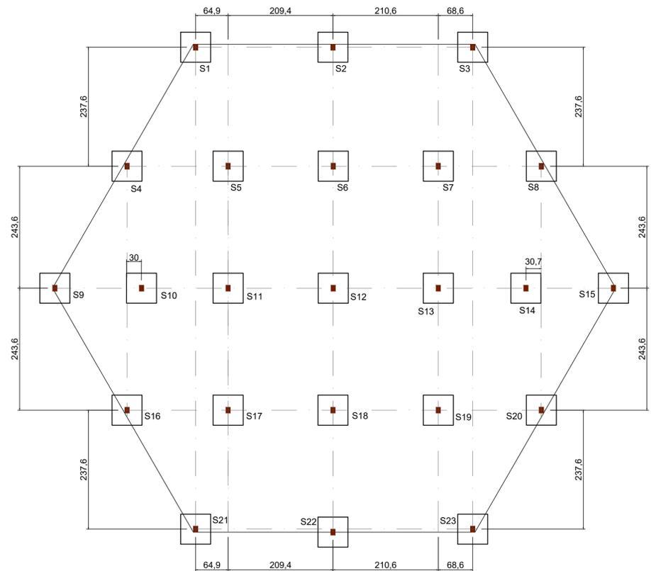
DETALHE - SAPATA PARA APOIO DOS PILARETES DE MADEIRA (23x3=69)
