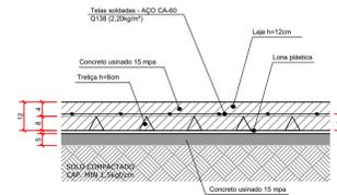
DETALHE CONSTRUTIVO DO PISO
