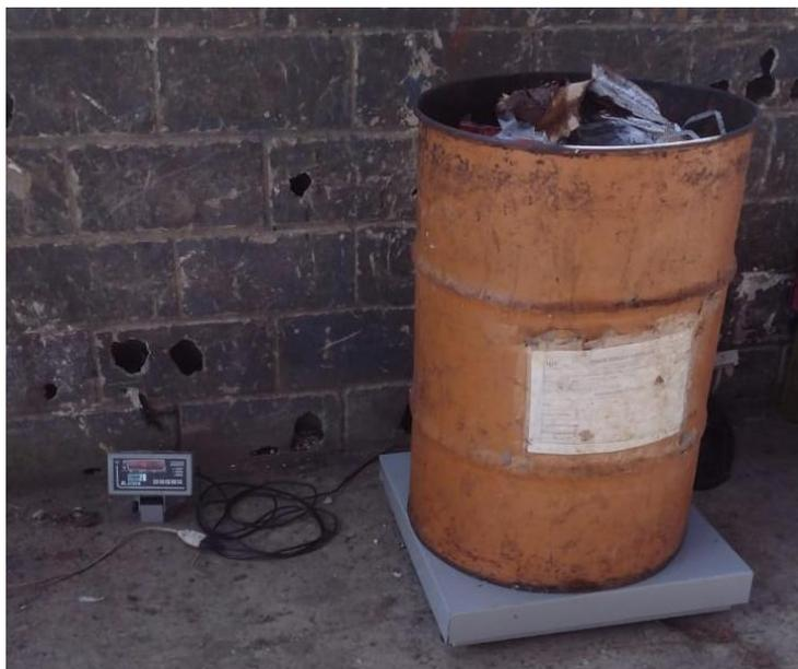
a) Pesagem da amostra para cálculo de densidade aparente
